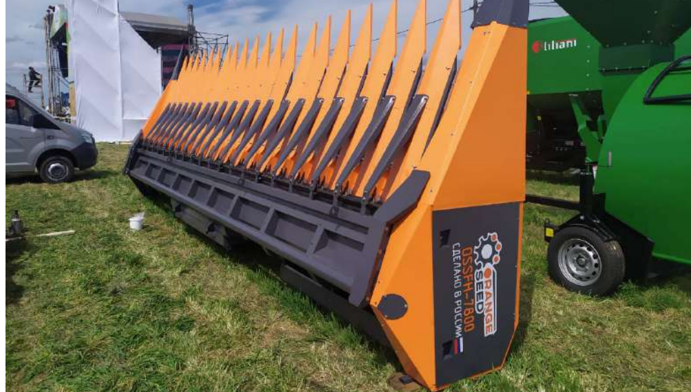
Жатка для уборки подсолнечника Orange Seed. Российское производство. Качество не уступает европейской технике
